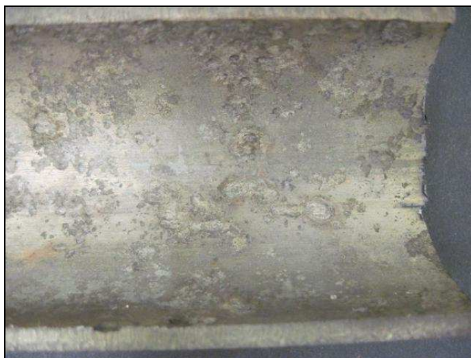
Fig. 27 : Tronçon 3, après décapage
